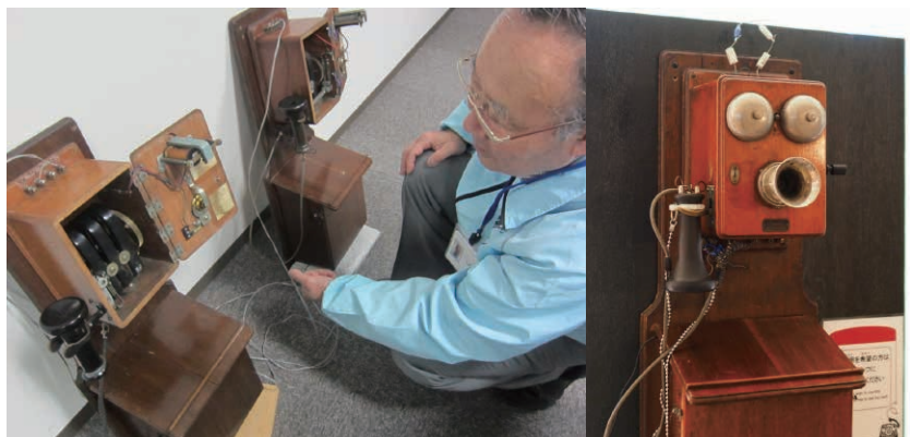
写真3 デルビル磁石式電話機の復元作業
