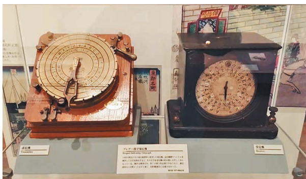
写真1 ブレゲー指字電信機 (レプリカ)
