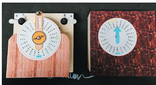
写真2 ブレゲー指字電信機の動作模型
