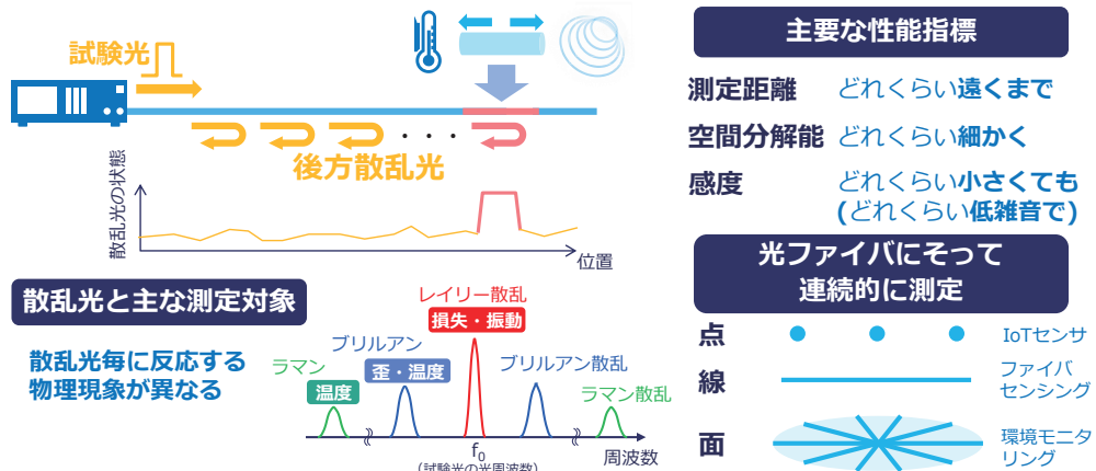
図1 光ファイバセンシング技術の概要
