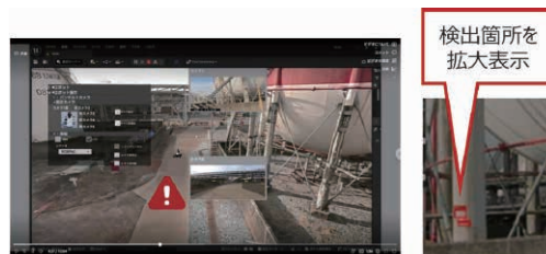
図4 デジタルツインでの化学プラント点検画面
